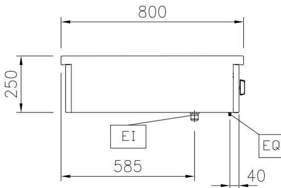
EI = Conexión eléctrica (energía)
